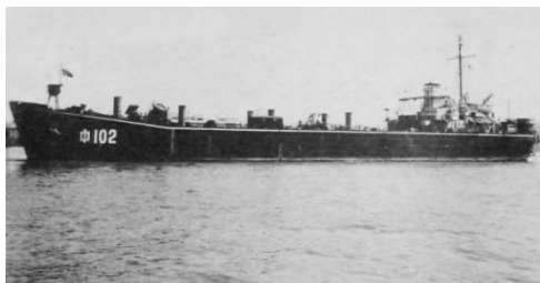
由戰車登陸艦撤除武裝改裝成 商船的招商局「中102」號。(圖 片來源：《招商局畫史-一個民族企 業的私家相簿》上海社會科學出版 院，2007)，頁169)
